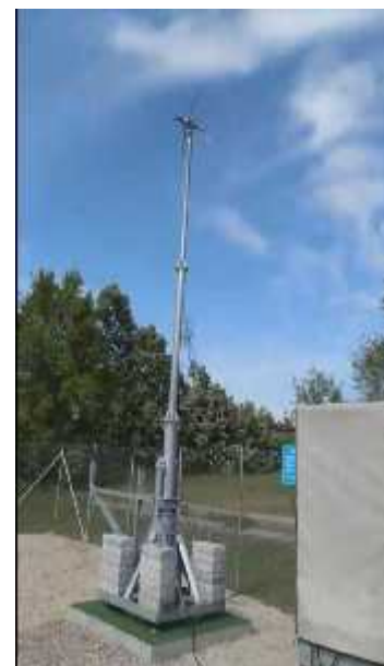
Слика 1. Преносиви мини-ветрогенератор с преклопним стубом типа „ђерма“, развијен у Институту „Михајло Пупин“, Београд
